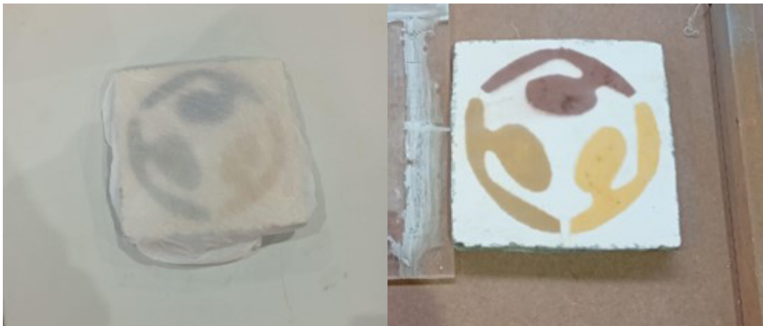
Figura 9: Ladrilho vedado em saco plástico (esquerda), Ladrilho após processo de cura (direita).
