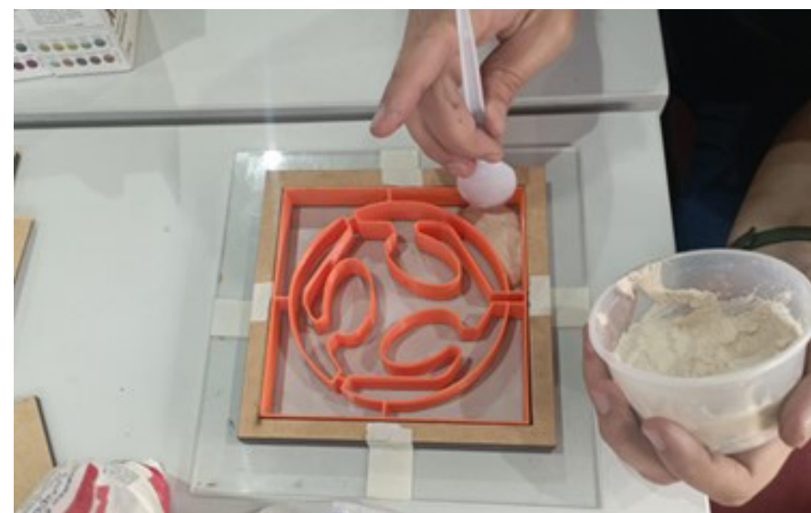
Figura 5: Preenchimento da forma com a mistura.
