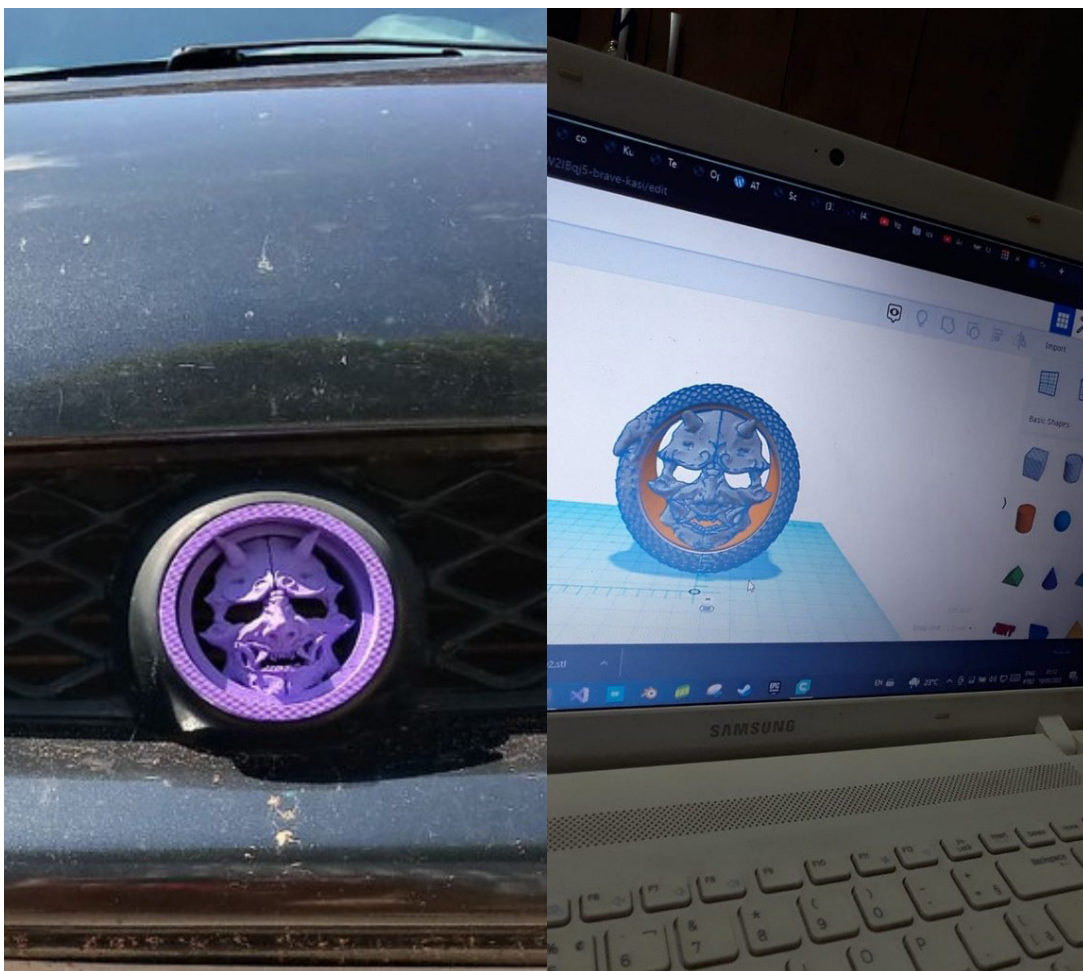
Figura 1 – Impressão de emblema versão 0.1 para carro feito com inserção de modelo baixado e versão 0.2 sendo projetada
